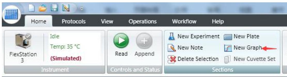
生成曲线拟合设置，X轴和Y轴，以及曲线数据来源，定义曲线名称和图表名称等功能，如下图所示：‘Graph Title’中填入该条图表的名称，一张图中可以有多个曲线。在该对话框中，‘Plot Name’中填入该条曲线的名称，即以后在数据计算中要引用的名字。‘Available Group’中选择所使用的原数据，该例中为Experiment 中的Standards在X-axis和Y-axis中可以通过下拉栏选择该曲线横坐标和纵坐标所用的数据，该例中选择Concentration 和MeanValue。
