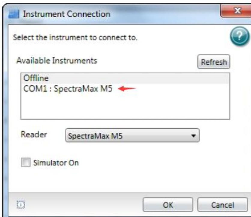
2) 该软件支持模拟操作模式，不同模式之间仪器图标显示如下图所示，如果想利用软件模拟练习仪器操作和数据管理，可以选择 Simulator On，在 Reader 选项中手动修改仪器型号，点击 OK 键，既可以进入模拟状态，这款软件几乎支持 Molecular Devices 目前在售所有类型（单功能和多功能）的酶标仪。
